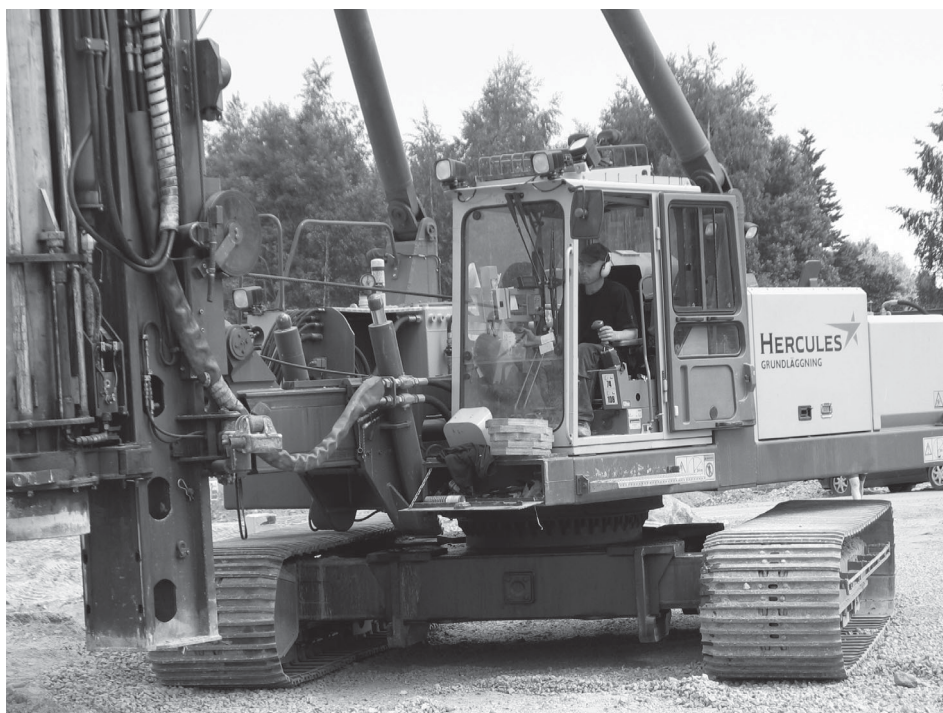
Robert Werme kör PB72 – HG 650, försedd med SuperRam-hejare. Imponerande drivningsförmåga!
