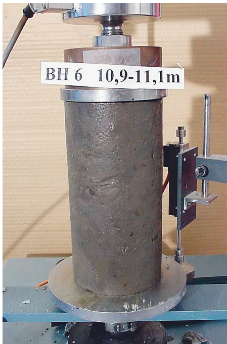
Bild 13: Enaxiella tryckförsök utförda på SGI i Linköping.
